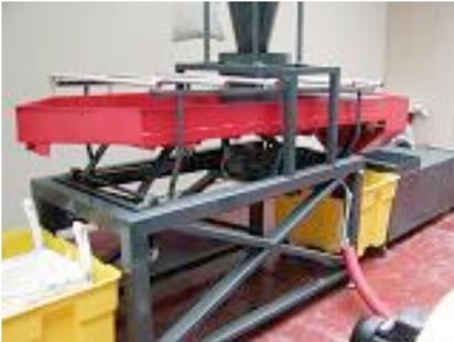
La table vibrante à séparation par voie humide permet la régulation des vibrations, de la pente de la table et du débit d'eau selon besoin et selon les matières traitées.
