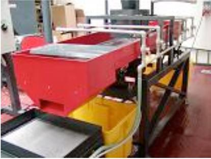
L'eau est renvoyée à travers le filtre vers le réservoir de collecte. Les résidus des impuretés mécaniques se déposent dans les compartiments de sédimentation. L'eau est ensuite renvoyée à nouveau dans le circuit fermé.
