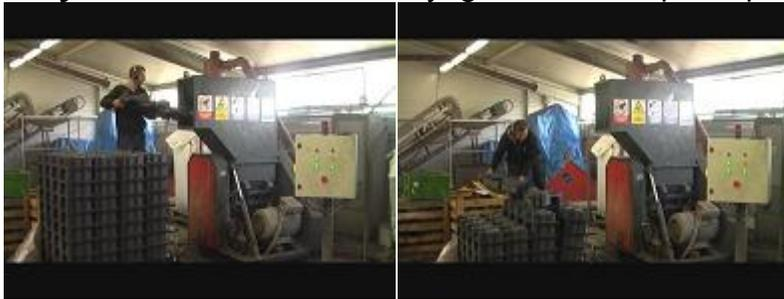
**Broyeur à 2 axes DR120:** destruction de boissons non-alcoolisées, suite date de péremption, préparation avant recyclage du plastiques.
