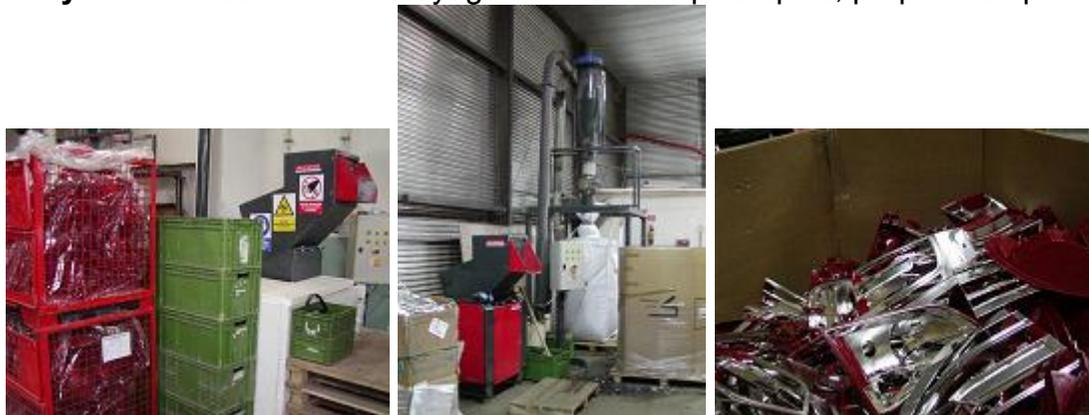
**Broyeur à 2 axes DR160:** broyage de déchets de cartons, préparation avant le briquetage.
