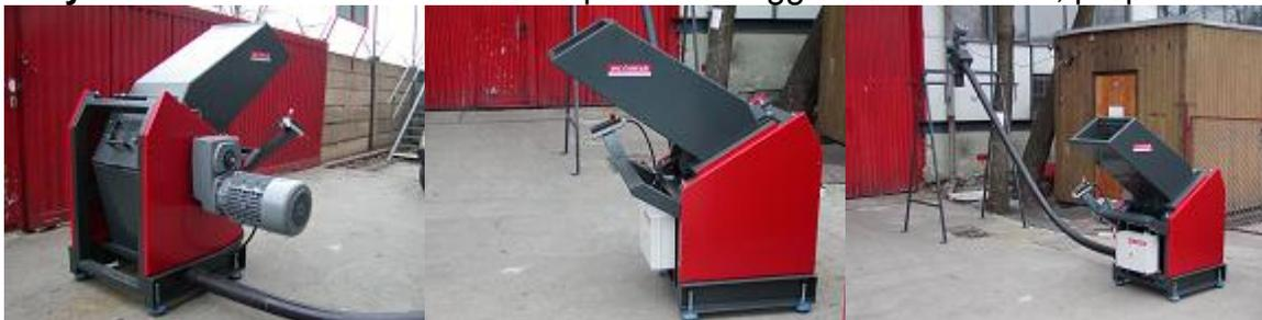
**Broyeur à 2 axes DR240 & broyeur à lames MN400:** déchets communaux et industriels, fabrication des combustibles alternatif.
