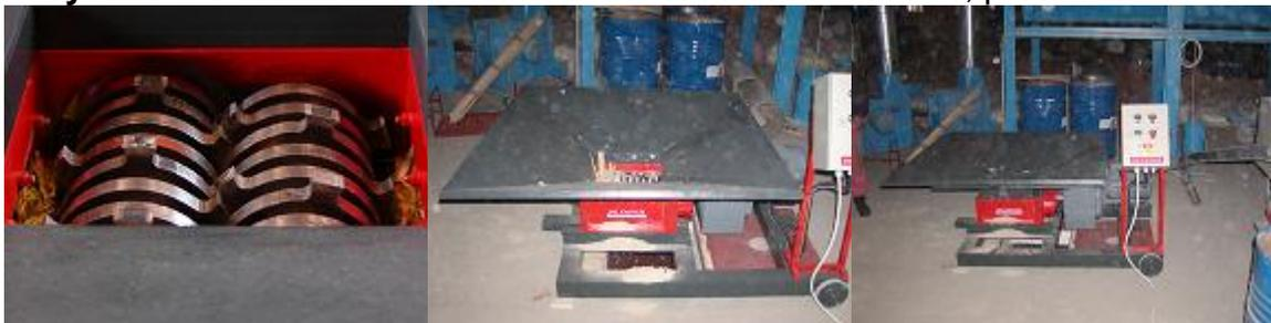
**Broyeur à 4 axes ARIES140 & broyeur à lames MN300:** câble et déchets DDDE, broyage et récupération des métaux.
