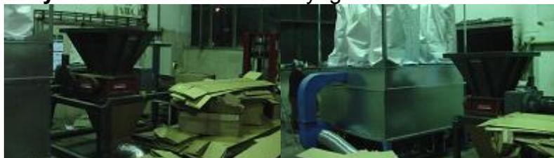
**Broyeur à 2 axes DR160 & Broyeur à lames MN300:** broyage des déchets plastiques automobiles, préparation avant le recyclage.
