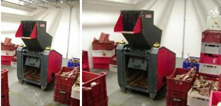
**Broyeur à 2 axes DR160:** broyage de chutes - fabrication de meubles, bois énergétique.
