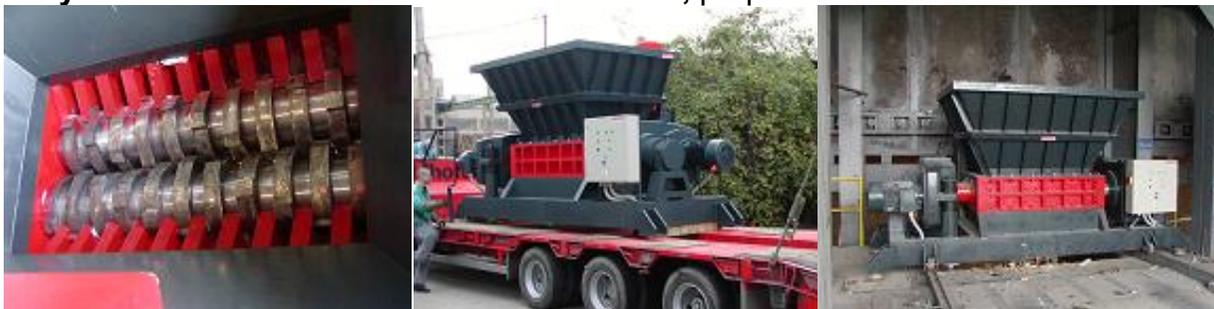
**Broyeur à lames MN400:** chutes de plastiques neufs, préparation avant recyclage.
