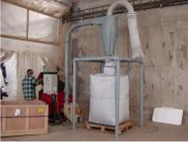
**Broyeur à 4 axes ARIES 240:** broyage de palette, fabrication du bois énergétique.
