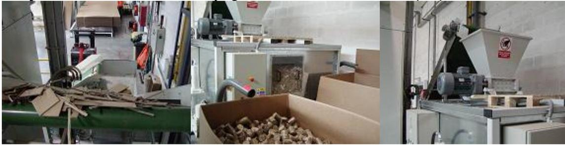
**Broyeur à lames SG400:** broyage de biomasse – préparation de la paille avant le pelletage.
