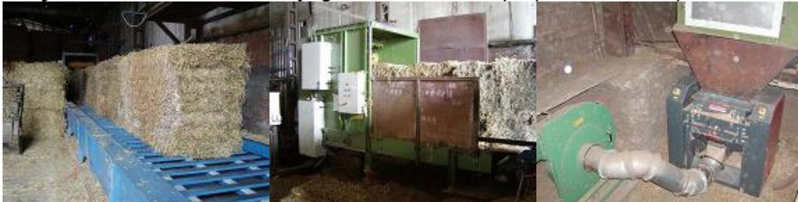
**Broyeur mono rotor CASTOR600:** broyage des déchets, résidus pétroliers.
