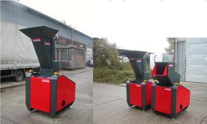
**Broyeur à lames SG400:** broyage des divers déchets plastiques, préparation avant le recyclage.
