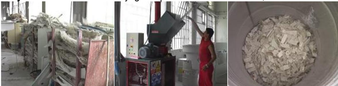
**Broyeur à 2 axes DR240:** broyage de tournures en acier, préparation avant briquetage.
