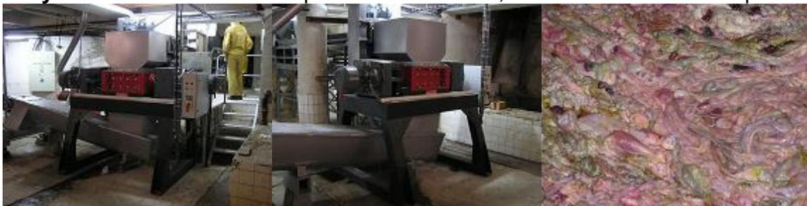
**Broyeur à 2 axes DR160:** broyage des chutes des plaques agglomérées, préparation pour la combustion dans une chaudière à fonctionnement automatique.
