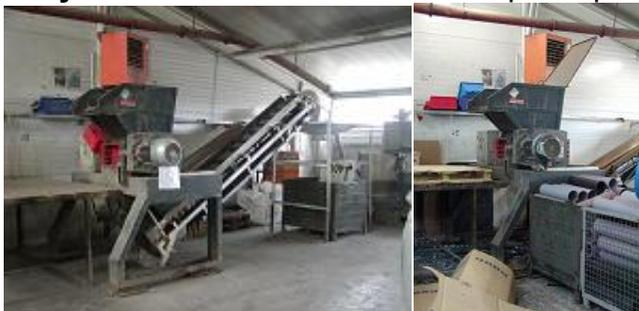
**Broyeur à 2 axes DR160 & broyeur à lames MN300:** la mousse polyuréthane PUR, broyage et affinage avant recyclage.
