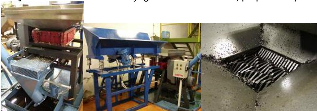
**Broyeur à 2 axes DR240 & broyeur à lames MN400:** broyage de sac avec farine d'os, puis affinage (combustible alternatif).
