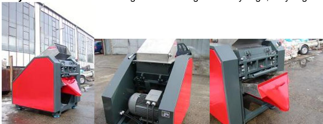
**Broyeur à 2 axes DR160:** broyage des matières textiles, préparation pour le recyclage.
