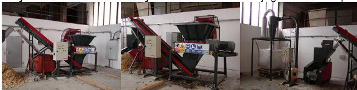
**Broyeur à 2 axes DR240:** broyage des déchets d'aluminium, préparation avant le recyclage.
