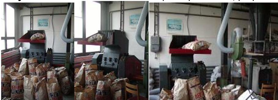
**Broyeur à lames MN300:** chutes de panneaux agglomérés et MDF, préparation avant combustion dans une chaudière automatique.
