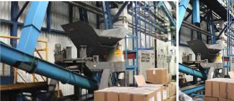
**Broyeu à 2 axes DR240:** tournures d'acier, préparation pour le briquetage.
