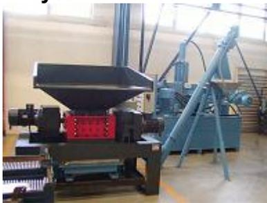
**Broyeur à 2 axes DR340:** déchets communaux, préparation avant combustion.
