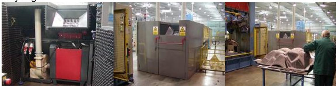
**Broyeur à lames SG400:** intégré dans une ligne de recyclage, recyclage des bouteilles PET, broyage des produits fortement humides.
