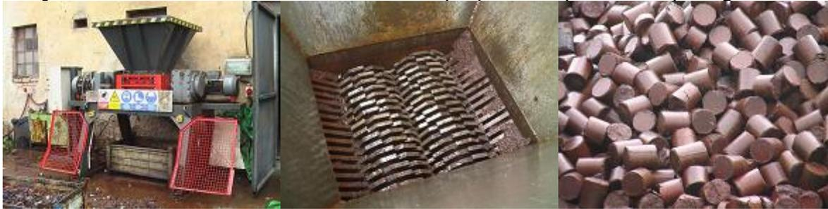
**Broyeur à 2 axes DR240 & broyeur à lames MN300:** broyage de bouteilles PET, préparation pour le recyclage.
