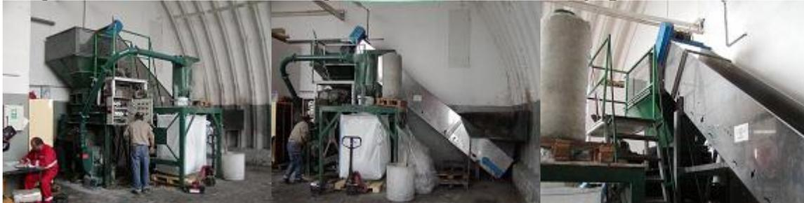
**Broyeur à 2 axes DR240:** déchets plastiques volumineux, préparation avant granulations.
