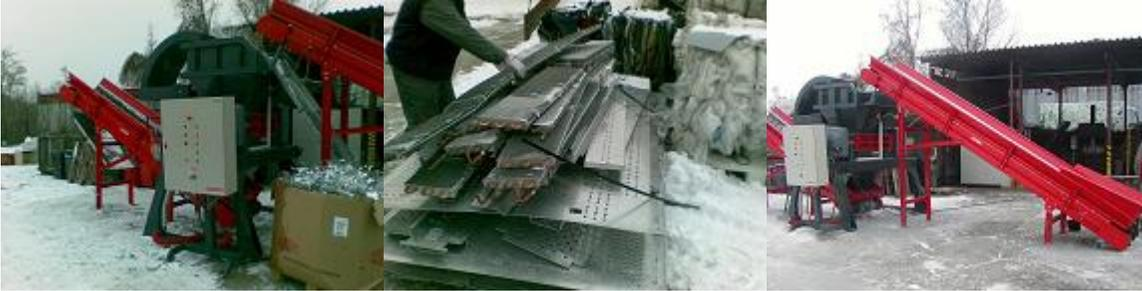
**Broyeur à lame MN300:** préparation pour le recyclage de récipients en plastique.
