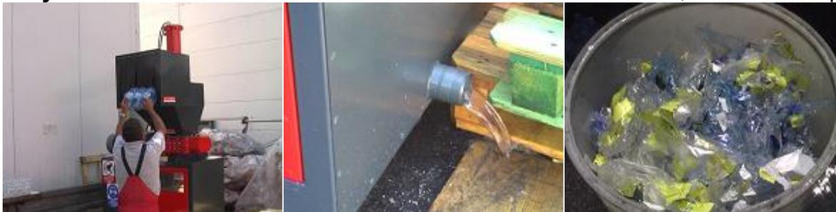
**Broyeur à 2 axes DR120:** broyage des déchets, papier, carton, préparation avant le briquetage.
