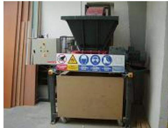
**Broyeur à lames MN300:** broyage des déchets plastiques, préparation pour le recyclage.
