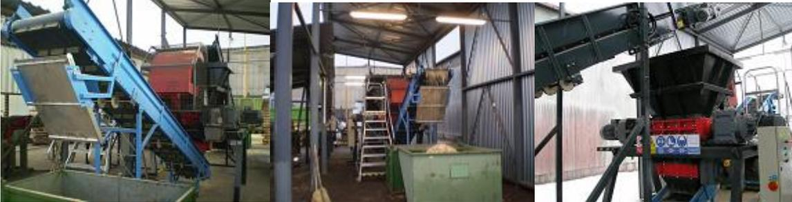
**Broyeur à 2 axes DR240:** tournures d'aluminium, préparation pour le recyclage.
