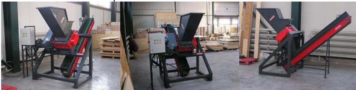
**Broyeur à 2 axes DR140:** broyage de tournures acier, préparation pour le briquetage.
