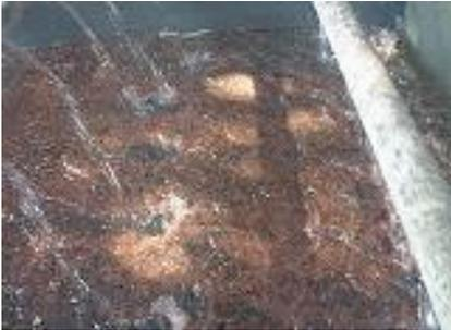
Le mouvement vibratoire de la table et les jets d'eau mettent les éléments du mélange métal et isolation plastique en mouvement. L'isolant plastique se déplace sur la surface du séparateur vers le bas. Les métaux avancent vers l'extrémité haute du séparateur et tombent dans le bac de récupération.
